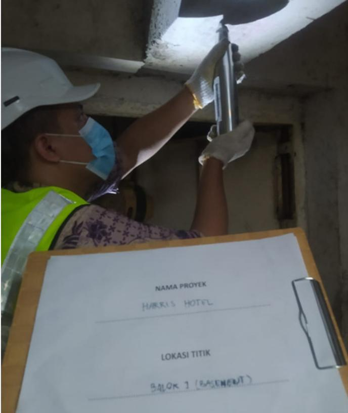
Hammer Test merupakan tes non destruktif pada beton untuk memperkirakan keseragaman kuat tekan beton.
